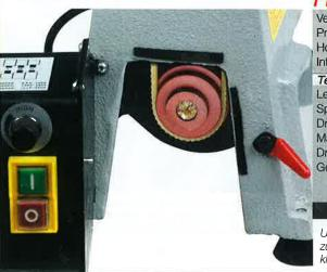
Um zum Umspannen an das Riemengetriebe zu gelangen, kann der Steuerkasten weggeklappt werden
